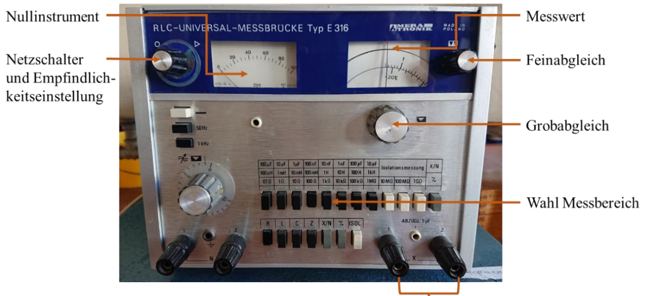
Abbildung 1: RLC-Messbrücke mit Erklärung der Bedienelemente
